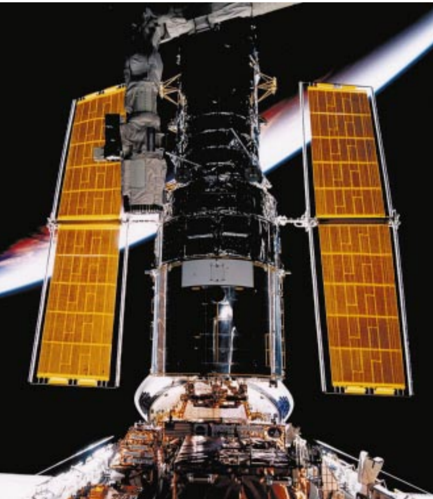
Das Hubble-Weltraumteleskop auf dem Andockadapter in der Ladebucht der Raumfähre bei der letzten Wartungsmission
